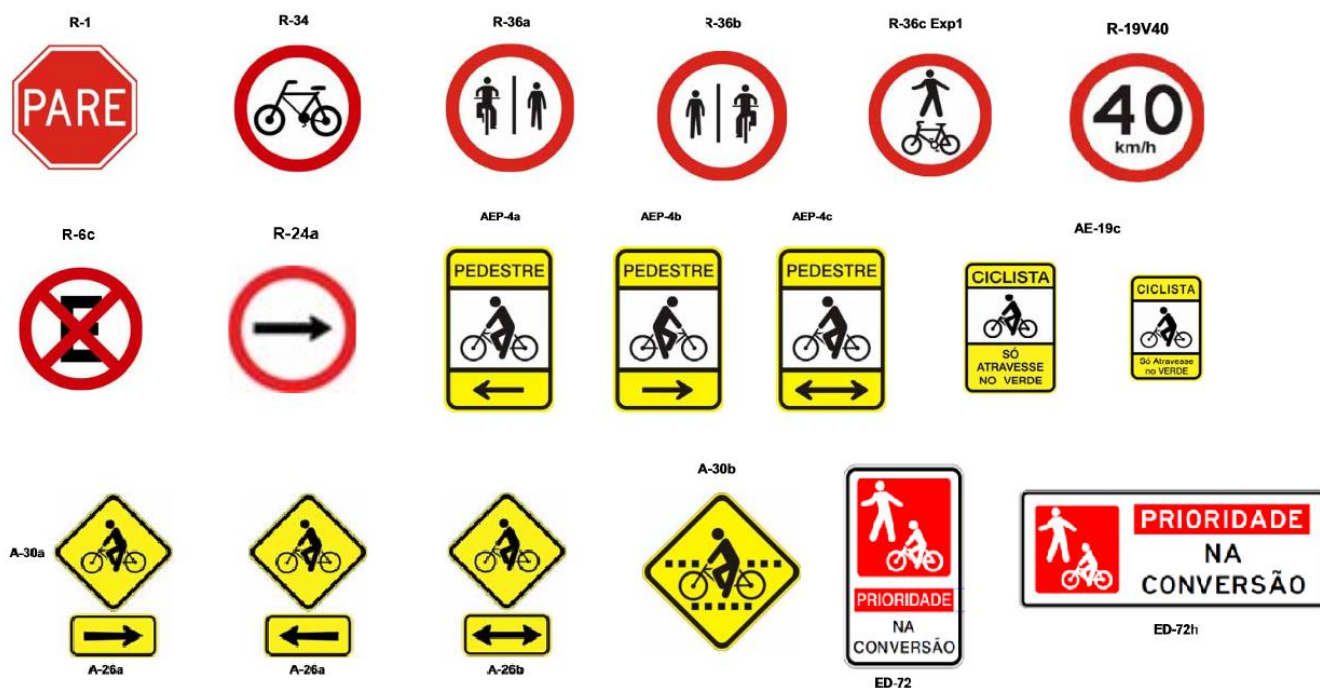
Figura 19 - Principais placas utilizadas em sinalização vertical ciclovária (Fonte: CET, 2014)
