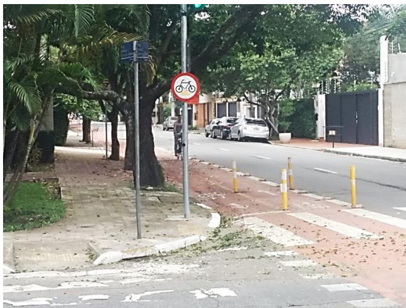
Figura 144 - Detalhe de sinalização vertical e horizontal do cruzamento (Fonte: Autoria própria)
