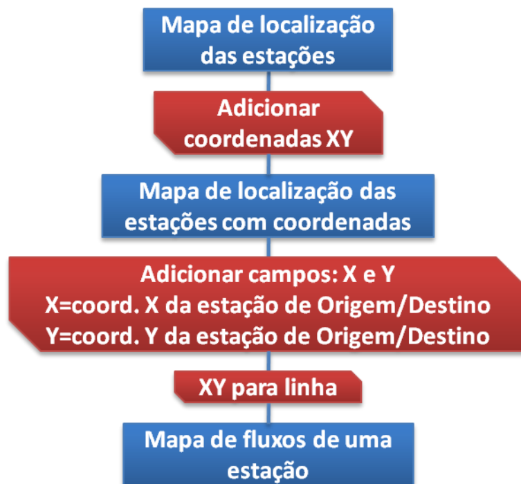
Figura 95 - Fluxograma do procedimento para obter o mapa de fluxos de uma estação do Bike Sampa (Fonte: Autoria própria)
